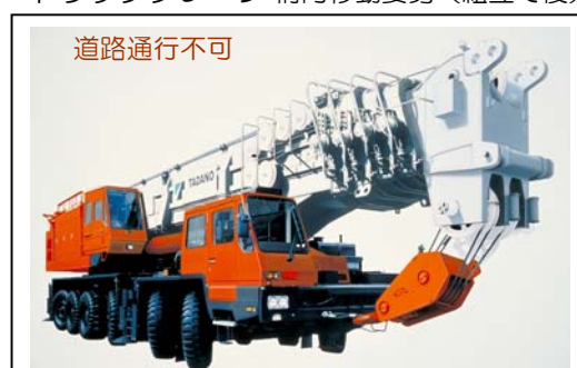
トラッククレーン 構内移動姿勢（組立て後）
